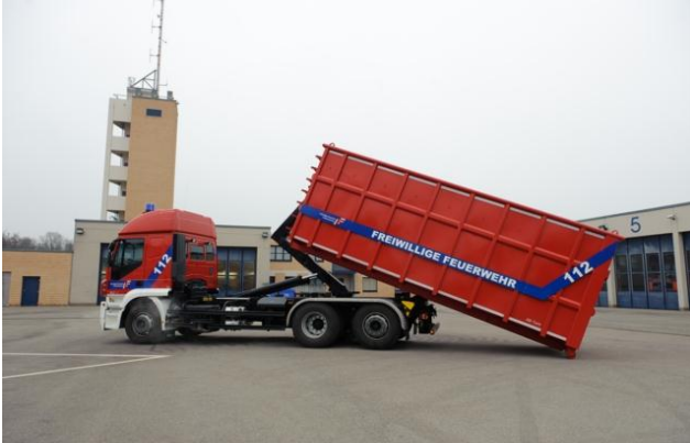
Wechselladersystem der Feuerwehr Friedrichshafen mit Geräten der Ölwehr
