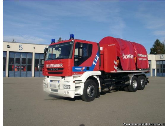
Wechselladersystem der Feuerwehr Friedrichshafen mit Geräten der Ölwehr
