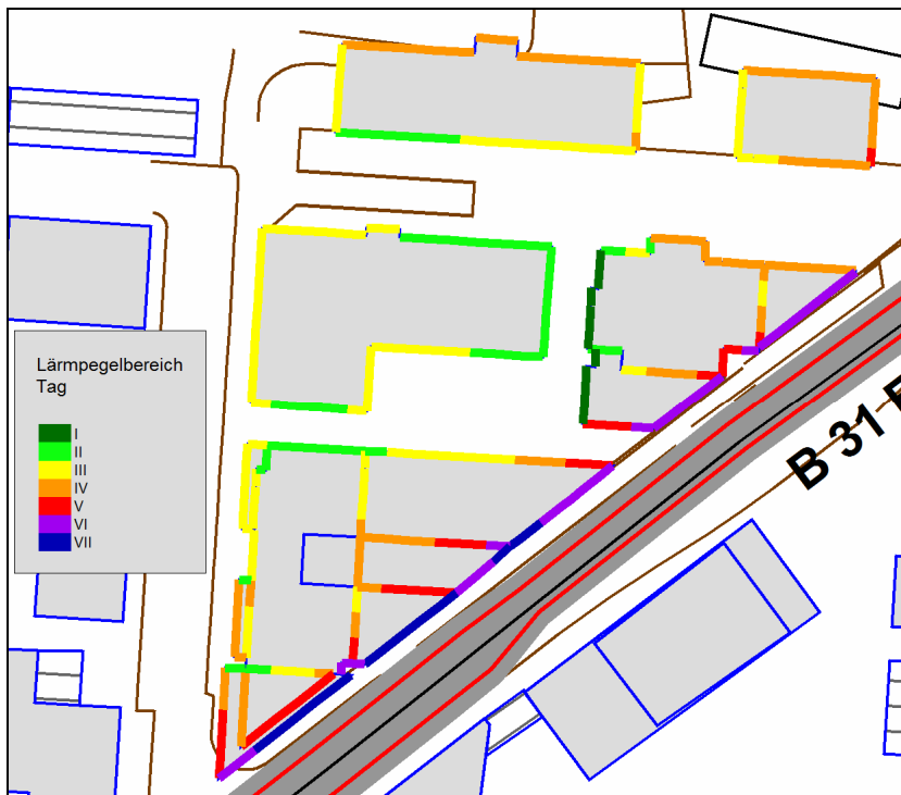
Abb. 1: Höchster Lärmpegelbereich der Gebäudeseiten am Tag
