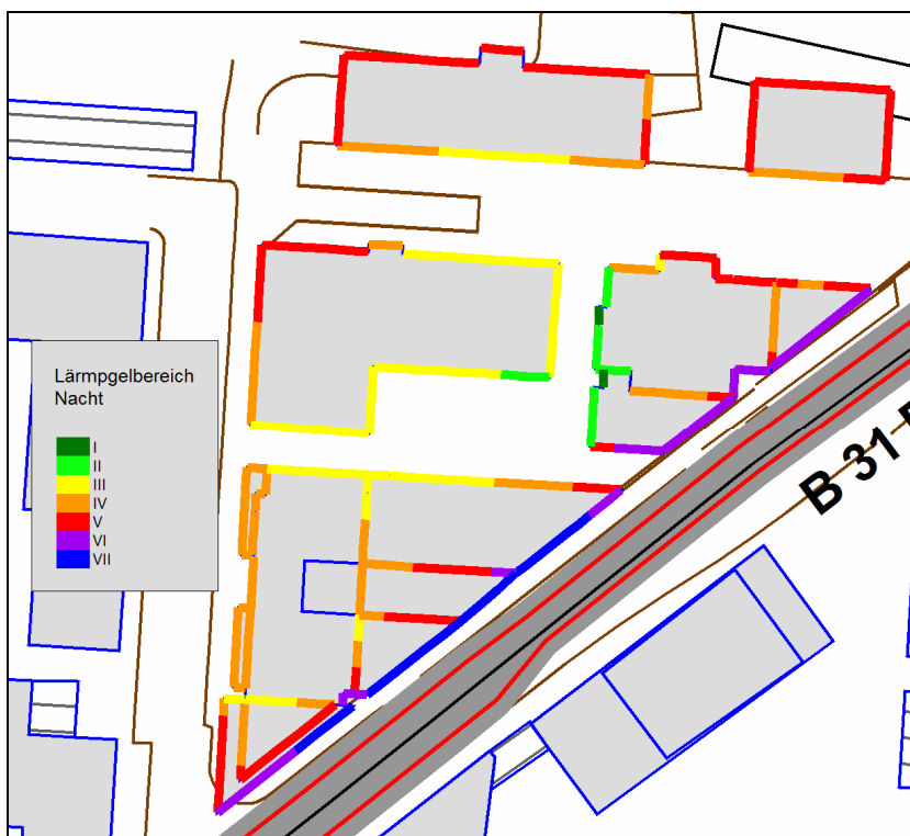
Abb. 2: Höchster Lärmpegelbereich der Gebäudeseiten in der Nacht
